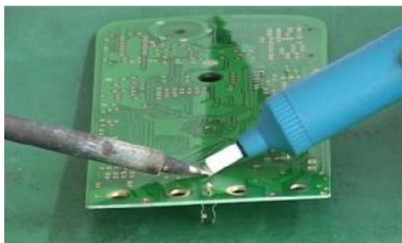
用吸锡器拆卸元器件
